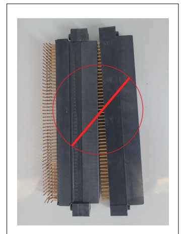
图C: 错误的拆卸方法
